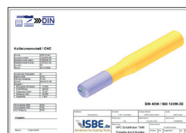
inkl. Kollisionsmodell nach DIN 4003 / ISO 13399-3D
